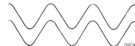
Fig. 6. - Tensione di entrata (in basso) e tensione di uscita (in alto) in classe AB, per  $I_Q = 1\%$  di  $I_P = 100$  mA, frequenza 1 kHz.
