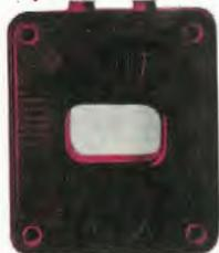
Per misure amperometriche in Corrente Alternata. Da adoperarsi unitamente al Tester 680 in serie al circuito da esaminare.
